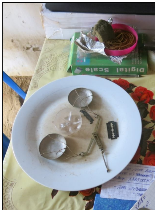
Fig. 9 Balance du négociant à main du négociant.
