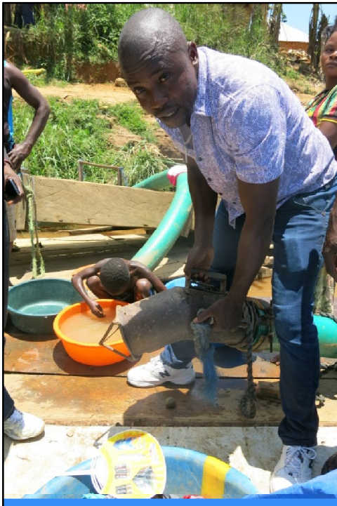
Fig. 7 Pointe du tuyau « suceur » qui est enfoncé dans les sédiments fluviaux par le plongeur
